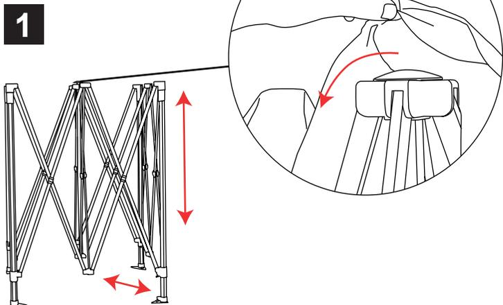
Retirer la structure du sac et l'étendre partiellement en tirant vers l'extérieur
