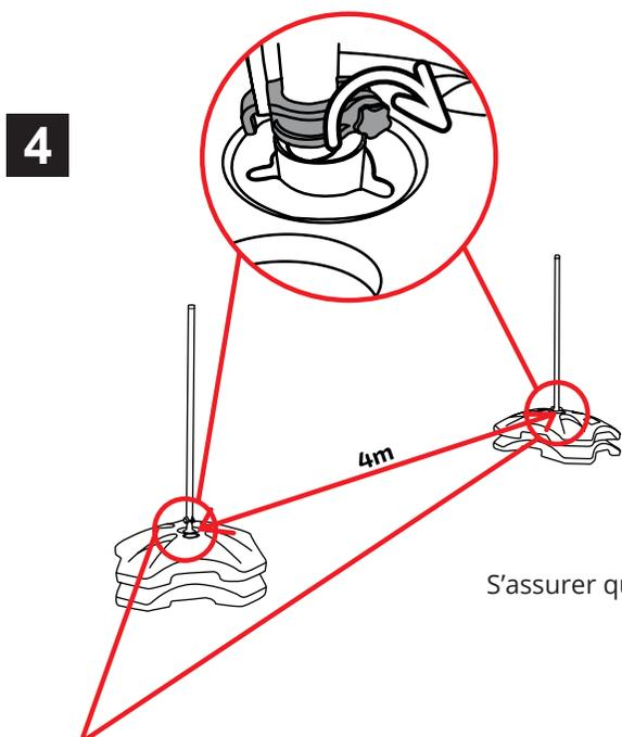
Serrer dans le sens des aiguilles d'une montre
